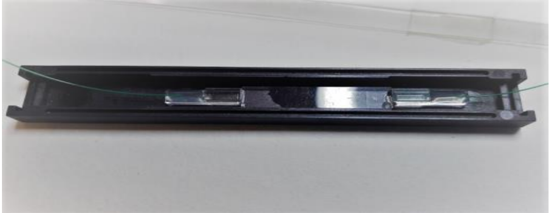
Obr. 2.2 Vzorek kanálového vlnovodu z křemičitého skla \text{Er}^{3+} a \text{Yb}^{3+} s iontovou výměnou, navázaný V drážkovými moduly a umístěný v obdélníkovém plastovém pouzdru
