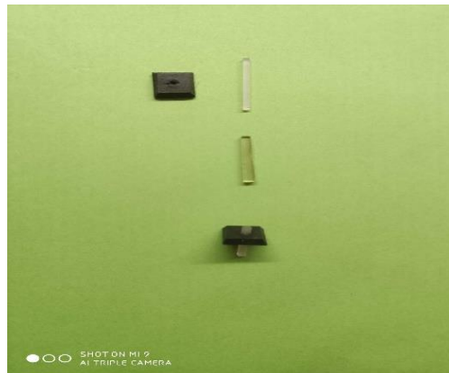
Obr. 2.3 Trámečky z křemičitého-germaničitého skla vzorky, T15 – T64 s aktivátory \text{Er}^{3+} a BAC – Ge a stínícími vložkami.
