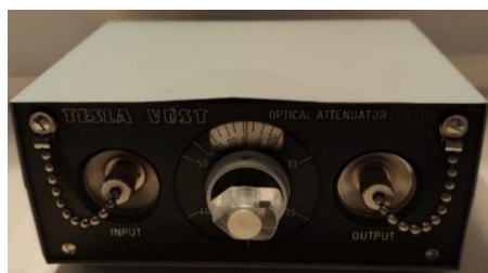
Obr. 4.21 Optický atenuátor TESLA VUST OA-GI I použitý při kalibraci výkonu dopadajícího luminiscenčního záření
