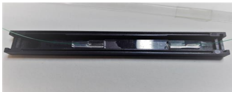
Obr. 5.1 Měřený vzorek Mix 1- C2 - K7 aktivního planárního difuzního vlnovodu dotovaného ionty \text{Er}^{3+} a \text{Yb}^{3+} , realizovaný na skleněném substrátu na bázi oxidu křemičitého iontovou výměnou \text{Ag}^+ \leftrightarrow \text{Na}^+ . Skleněný vlnovodný modul je uprostřed pouzdra a na obou stranách jsou V drážkové moduly pro připojení optických vláknových vlnovodů
